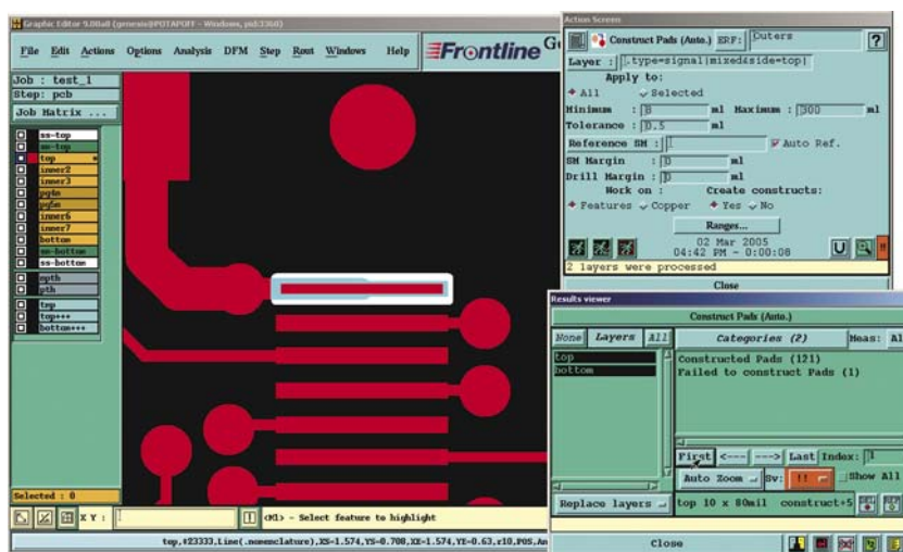
Рис. 8. Автоматическое преобразование неправильно нарисованных контактных площадок во флешы
