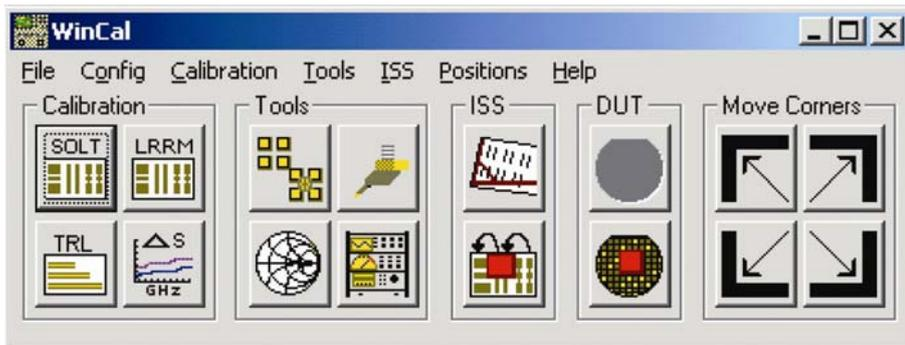
Калибровочное программное обеспечение Cascade WinCal делает возможным LRRM калибровку, считывание и сохранение S-параметров в формате Touchstone.
