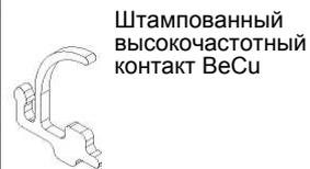
Штампованный высокочастотный контакт BeCu
