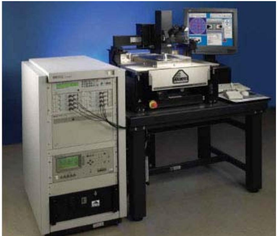
Типичное решение включает в себя зондовую установку Summit, измерительные приборы Agilent Technologies и совместимое программное обеспечение.
