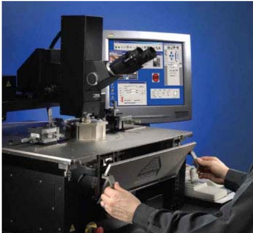
Запатентованная Микро Камера (Micro Chamber) революционизировала испытания схем на полупроводниковой пластине. Она дает возможность проводить испытания при любой температуре в светонепроницаемой, бесшумной среде, защищенной от электромагнитного излучения.
