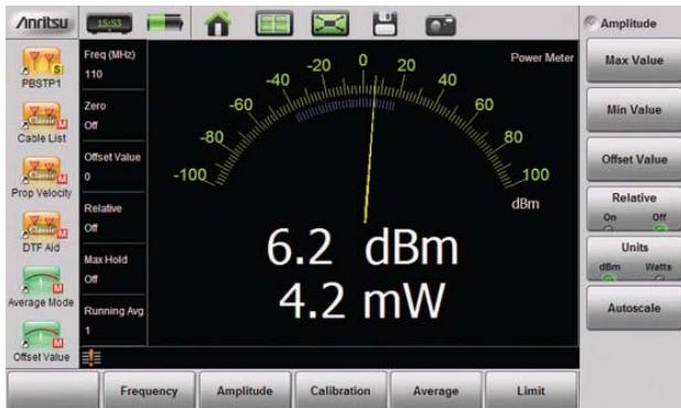
Измерительный экран встроенного измерителя мощности
