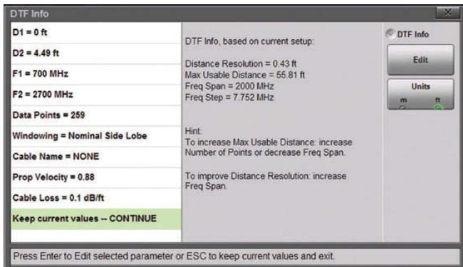
Экран меню помощи при измерении расстояния до повреждения в «Классическом режиме»
