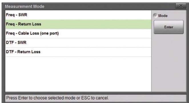
Экран выбора типа измерения в «Классическом режиме».
