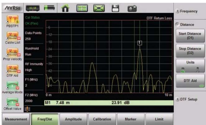
Экран измерения расстояния до повреждения («Продвинутый режим»)
