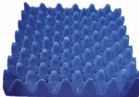
Верхняя часть C-RAM FAC имеет волнистую форму, что обеспечивает постепенное уменьшение сопротивления. Этот механизм очень эффективен для минимизации прямых отражений, особенно на высоких частотах. Данный продукт является «рабочей лошадкой» индустрии для частотных диапазонов от 15ГГц и выше. Для лучшей производительности на более низких частотах рекомендуются продукты серии SFC.
