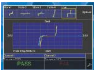
Проверка V-I вместе со сравнением с хранимой кривой
