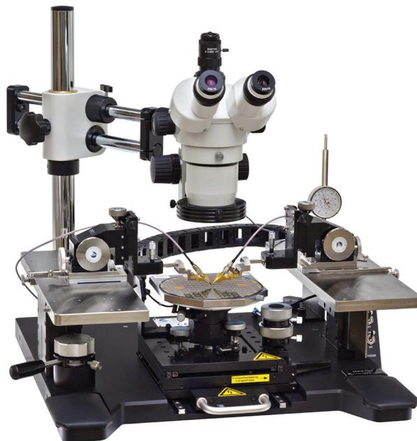
EPS150RF - это специально сконфигурированная зондовая станция для получения точных результатов в кратчайшие сроки с максимальной уверенностью в их достоверности на пластинах диаметром до 150 мм. В станции применяются наиболее известные методики, позволяющие проводить ВЧ-измерения на частотах до 67 ГГц на контактных площадках от 25 мкм x 35 мкм.
