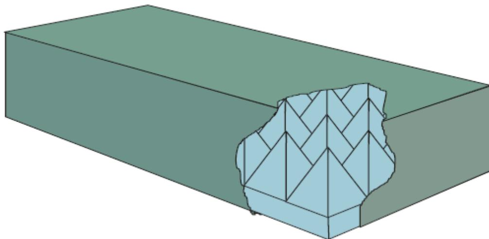
Материалы серии C-RAM SFC-RI-NT – это абсорберы C-RAM SFC (Т.о. 390-1), выполненные в форме прямоугольного блока, покрытого водозащитной неопреновой тканью.
