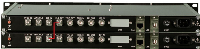
Рисунок 16: Образец подключения синхронизации двух многоканальных генераторов MCSG через опорный генератор в 3 ГГц.
