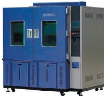
Камера испытания светодиодных изделий
