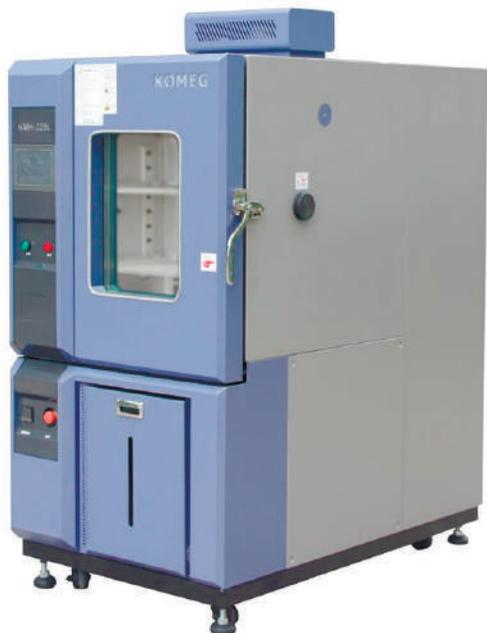
КМН-408S Климатическая испытательная камера
